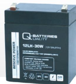
Bei den Q-Batteries Hochstromtypen handelt es sich um AGM-Akkus (Blei-Vlies-Technologie), die speziell für Hochstromanwendungen konzipiert wurden. Aufgrund der größeren Oberfläche der Bleiplatten, kann kurzfristig ein sehr hoher Strom, beispielsweise für USV-Anlagen bereitgestellt werden.
