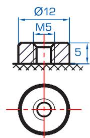
F13 (Schraubanschluss M5)
