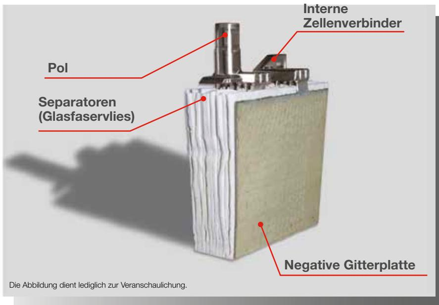
BEI DER SLA BAUREIHE WIRD DIE BEWÄHRTE AGM TECHNOLOGIE (ABSORBED GLASS MAT) EINGESETZT. DAS ELEKTROLYT IST VOLLSTÄNDIG IN MIKROPORÖSEN GLASFASER SEPARATOREN GEBUNDEN MIT 99% INTERNER REKOMBINATION. DIE GEHÄUSE SIND ROBUST UND DICHT. WÄHREND DER GESAMTEN GEBRAUCHSDAUER SIND DIE BATTERIEN VOLLSTÄNDIG WARTUNGSFREI. DIE GERINGE SELBSTENTLADUNG ERMÖGLICHT EINE LAGERFÄHIGKEIT VON 6 MONATEN OHNE NACHLADEN.
